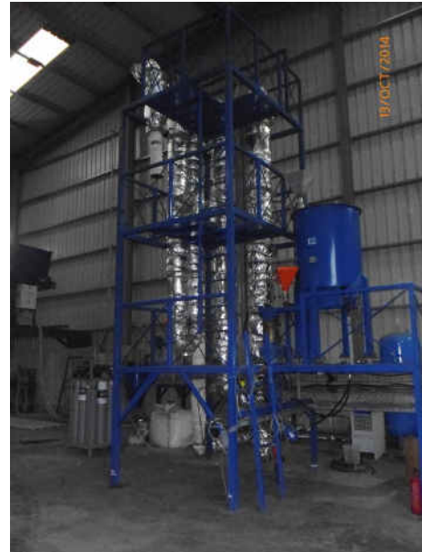
Εικόνα 6. Ολοκληρωμένη μονάδα αεριοποίησης με ρευστοποιημένη κλίνη ανακυκλοφορίας.
